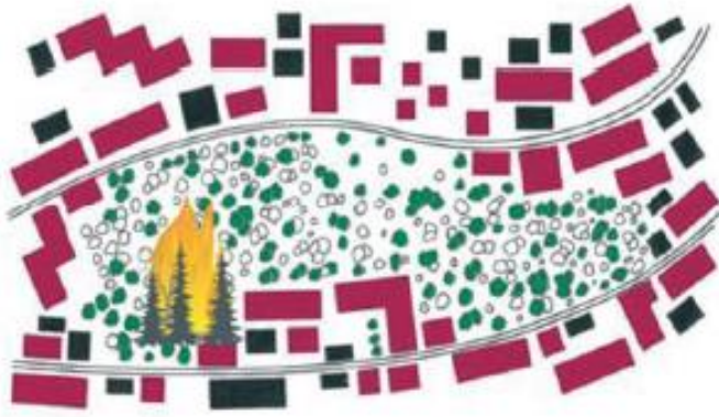
Fig. tratta dal Piano regionale AIB – Schema rappresentativo di una situazione di interfaccia occlusa.
